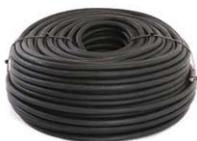
Cavo elettrico con eccezionali doti di flessibilità. Ottima resistenza meccanica all'abrasione, torsione e calore. Guaina esterna in Caucciù, spessore 3mm., con intercapedine d'aria sottostante. Treccia di rame formata da capillari diam. 0,07 mm cordati a passo estremamente ridotto per assicurare un raggio di curvatura minimo.
