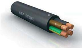
Cavo elettrico flessibile con conduttori in rame rosso stagnato o non stagnato isolati in gomma sintetica di qualità EI4 e guaina esterna in policloroprene (neoprene) di qualità EM2. Estremamente flessibile anche alle basse temperature; ottima resistenza meccanica all'abrasione, torsione, trazione e agenti atmosferici.
