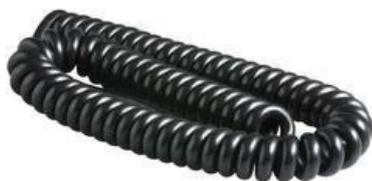
Cavo elettrico flessibile con conduttori in rame rosso, isolati in PVC (polivinilcloruro) di qualità T11/TI2 e guaina esterna in POLIURETANO speciale. Estremamente flessibile anche alle basse temperature; particolare resistenza meccanica all'abrasione, schiacciamento, torsione, taglio e trazione, agli oli, grassi, lubrificanti, saponi ed agenti atmosferici. Spiralatura permanente che consente l'allungamento fino a 4,5 volte la lunghezza a riposo. Fornito in
