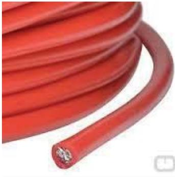
Cavo elettrico ad alta flessibilità e doppio rivestimento. Ottima resistenza meccanica all'abrasione, torsione, schiacciamento oli e solventi industriali. Guaina esterna in PVC e guaina interna in PVC ad alta resistenza termica. Treccia di rame formata da capillari diam. 0,25 (sez.16-25mmq.) o 0,30 (altre sezioni).
